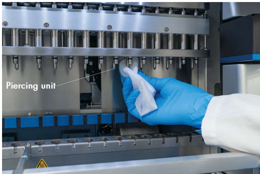
Figur 174. Rengøring af EZ2-boreenhed.
