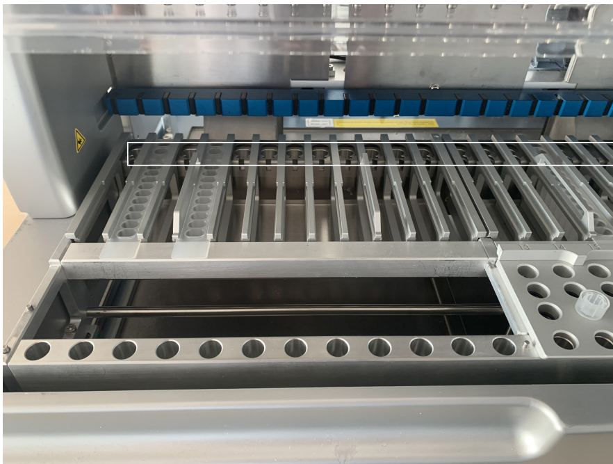
Figur 17. Positioner i patronstativet, som tåler opvarmning (fremhævet med hvid ramme).
