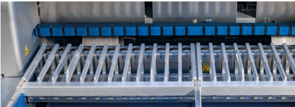
Figur 12. Aftageligt patronstativ inde i instrumentet.
