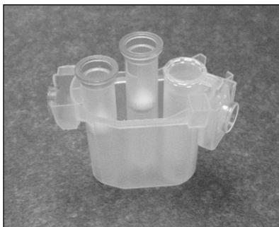
**正确装载的转子适配器。** **A** 转子适配器加载正确，1.5 ml 微量离心管的盖子位于正确位置；**B** 正确装载的转子适配器侧视图。
