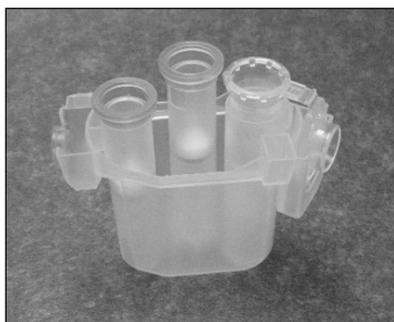
**错误装载的转子适配器。** **C** 以错误方式装载了 1.5 ml 微量离心管的转子适配器。管的盖子未完全推至转子适配器插槽底部，盖子可能会在离心过程中折断（请对比上图的 **A**）。**D** 错误装载的转子适配器（请对比上图的 **B** 部分）。
