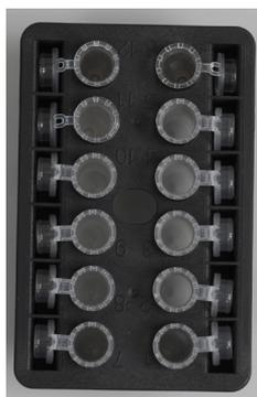
样本试管的管盖必须牢固地放入震荡器架边缘的插槽中
