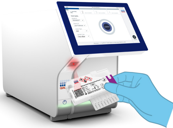
Figura 11. Leitura do código de barras do QIAstat-Dx Gastrointestinal Panel 2 Cartridge.
