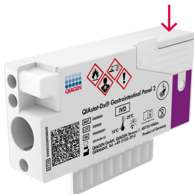
Figure 16. Placement du code à barres de l'ID d'échantillon
