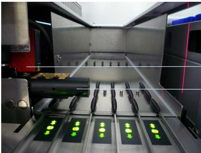
Plassering av strekkodeleser og avstandsstykke.
