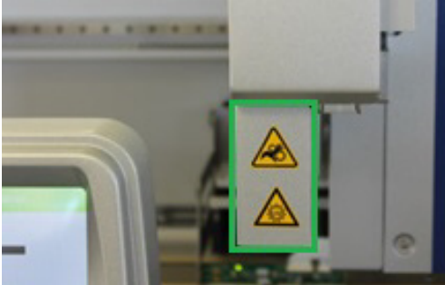
† Plassering av varselmerket om knusefare og varselmerket om UV-lys (SP/AS).
