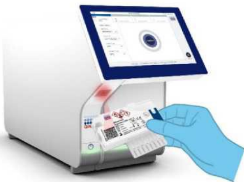
45-сурет. QIAstat-Dx Respiratory SARS-CoV-2 Panel панелінің штрих-кодын сканерлеу.
