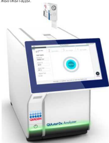
15-сурет. QIAstat-Dx Respiratory SARS-CoV-2 панелінің картриджін QIAstat-Dx Analyzer 1.0 анализаторына салыңыз.
