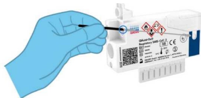
8-сурет. QIAstat-Dx Respiratory SARS-CoV-2 Panel картриджіне тампон салу.
