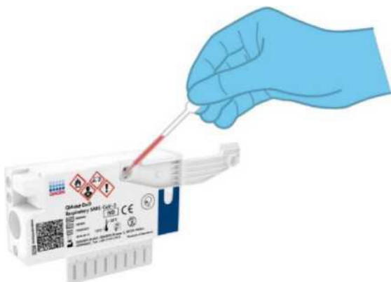
41-сурет. Үлгіні QIAstat-Dx Respiratory SARS-CoV-2 Panel картриджінің негізгі портына тасымалдау.
