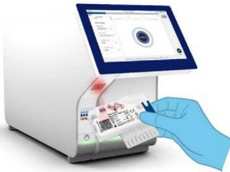
12-сурет. QIAstat-Dx Respiratory SARS-CoV-2 Panel панелінің штрих-кодын сканерлеу.
