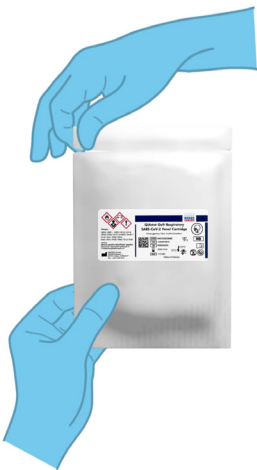
Kuva 5. QIAstat-Dx Respiratory SARS-CoV-2 Panel Cartridge -kasetin avaaminen.
