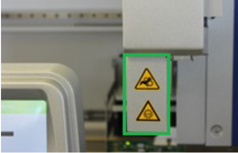
† ตำแหน่งของฉลากแจ้งเตือนอันตรายจากการมีขั้ว และฉลากแจ้งเตือนแสง UV (SP/AS)
