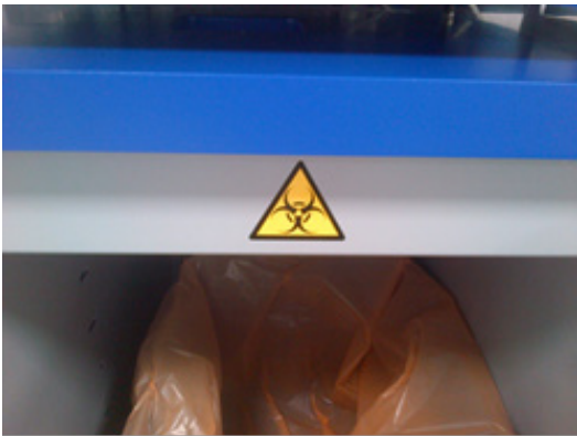
* ตำแหน่งของฉลากแจ้งเตือนอันตรายทางชีวภาพบนแผงคามิเน็ต (SP)
