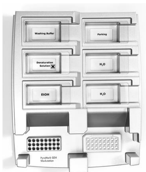
Figur 2. Plassering av PCR-plate (eller remser) og PyroMark Q24-plate på vakuumarbeidsstasjonen.
