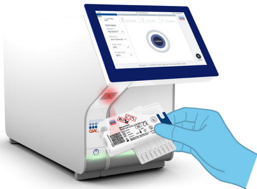
25. attēls. QIAstat-Dx SARS-CoV-2/Flu A/B/RSV Panel Cartridge kasetnes svītrkoda skenēšana.
