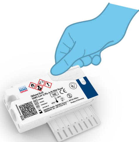
22. attēls. Galvenās atveres parauga nodalījuma vāka aizvēršana.
