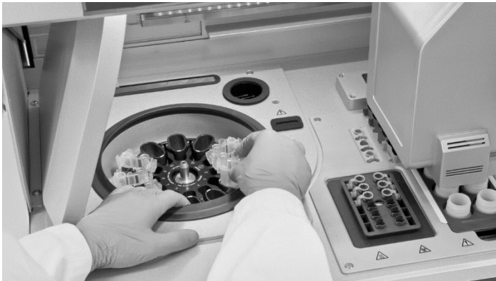
Figur 21: Lasting av sentrifugen på QIAcube Connect MDx. Last de monterte rotoradapterne i sentrifugebeholderne.
