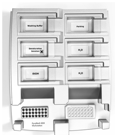
Фигура 2. Място за PCR плаката (или епруветките) и PyroMark Q24 plate във вакуумната работна станция.
