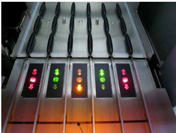
Τερματική γραμμή Υποδοχή 1-4 Υποδοχή A Παραδείγματα φωτισμού των λυχνιών LED για την κατάσταση της υποδοχής.
